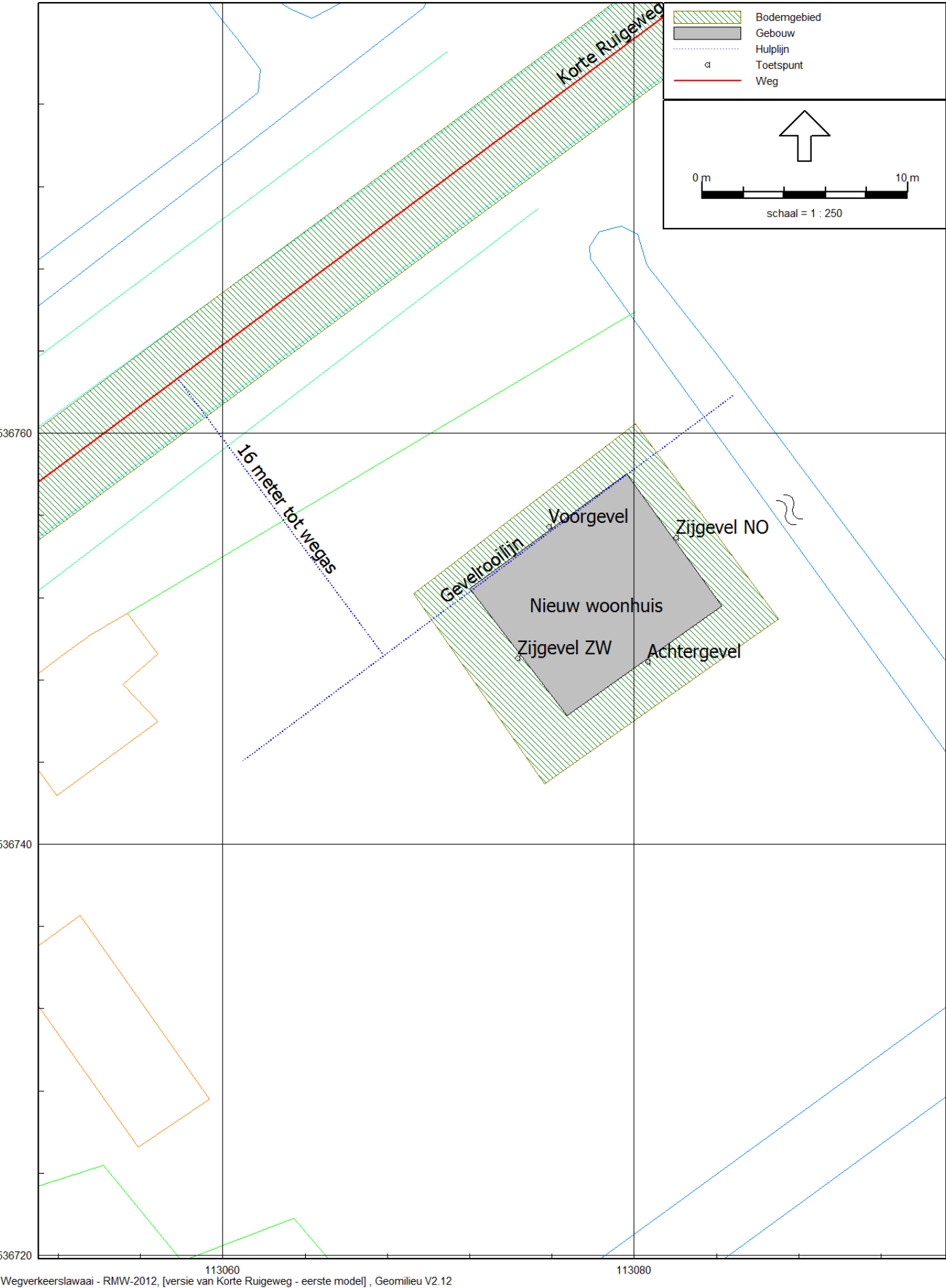
Woning met beoordelingspunten op de gevels
